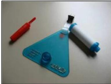
**Figure 10 : Echantillonneur passif**
