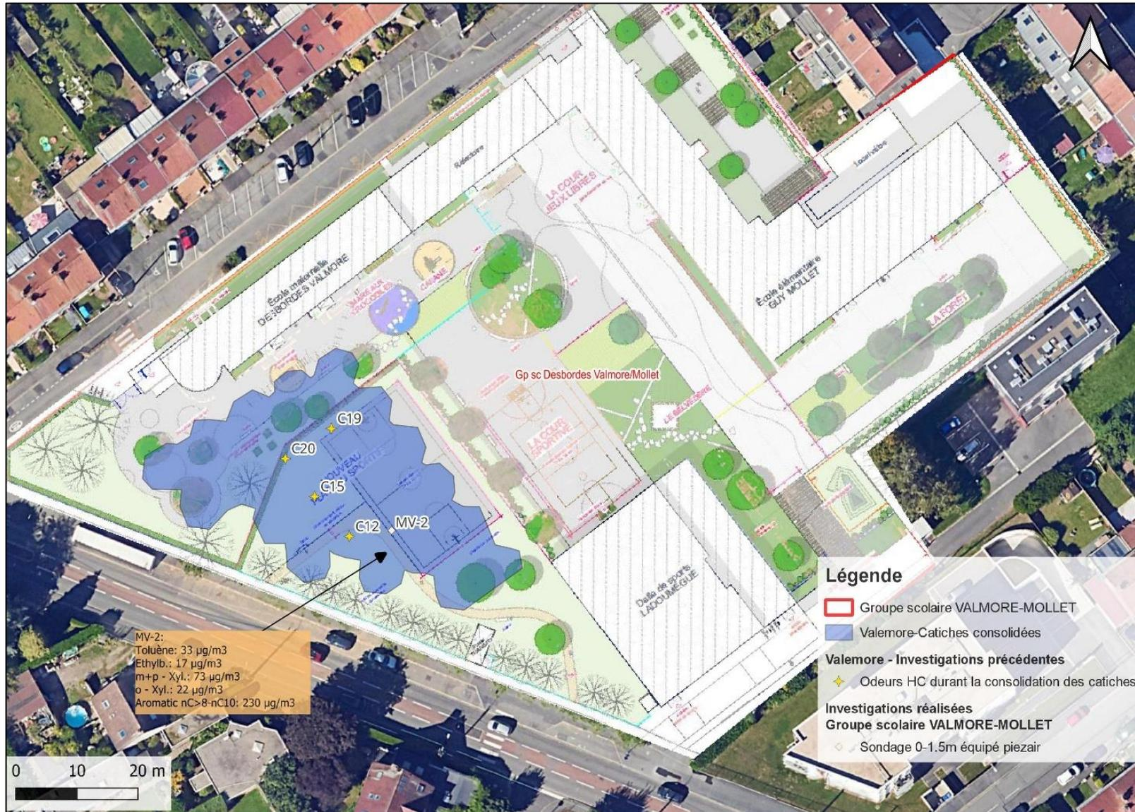
Figure 9 : Localisation des piézairs et synthèse des impacts dans les gaz des sols
