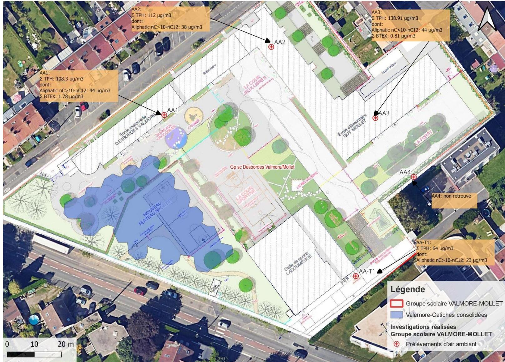
Figure 5 : Localisation des capteurs d'air ambiant et synthèse des anomalies de concentrations
